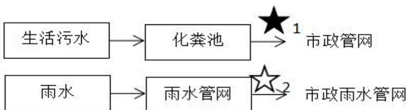
图 3-1 废水、雨水排放走向图
