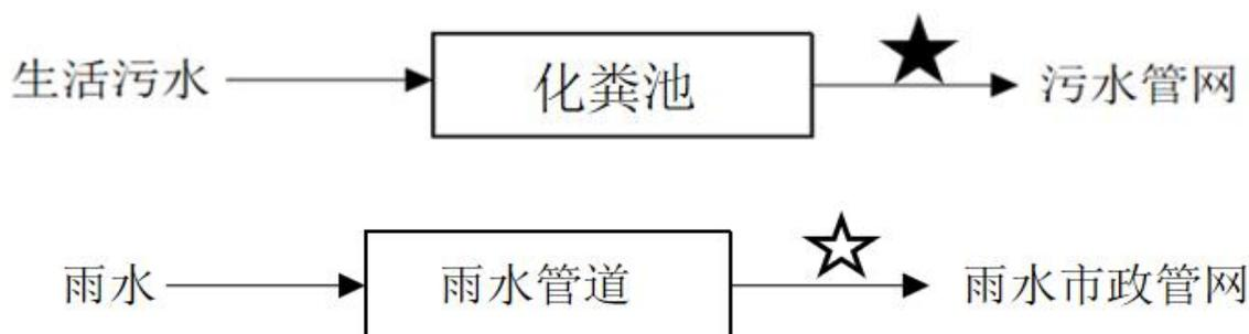
图 6-1 废水及雨水监测点位图
